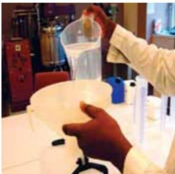
1. L'alcool pour la formule à utiliser est versé dans la grande bouteille ou le réservoir jusqu'à la marque graduée.
