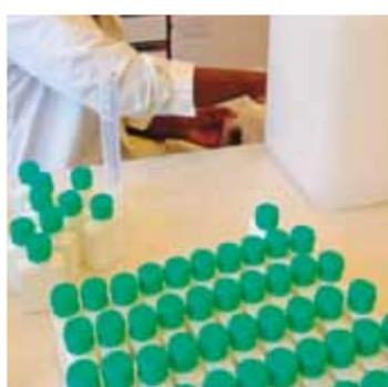
7. Divisez immédiatement la solution dans ses derniers récipients (par exemple, des bouteilles en plastique de 500 ou 100 ml) et placez les bouteilles en quarantaine pendant 72 heures avant de les utiliser. Cela laisse le temps de détruire les spores présentes dans l'alcool ou dans les bouteilles neuves/réutilisées.
