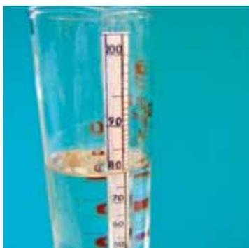
2. L'analyse post-production est obligatoire si l'on utilise de l'éthanol ou une solution d'isopropanol. Utilisez un alcoomètre pour contrôler la concentration d'alcool de la solution d'utilisation finale. Les limites acceptées doivent être fixées à  $\pm 5\%$  de la concentration cible (75%-85% pour l'éthanol).
