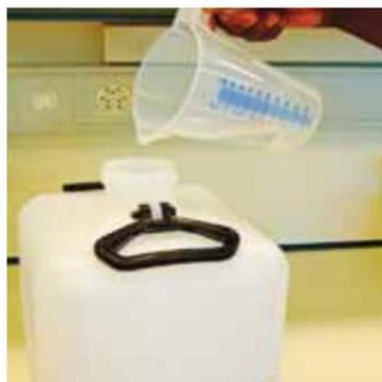
4. La bouteille/réservoir est ensuite remplie jusqu'à la marque des 10 litres avec de l'eau distillée stérile ou de l'eau bouillie froide.
