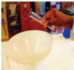
3. Ajouter le glycérol en utilisant un cylindre gradué. Le glycérol étant une substance visqueuse adhérent aux parois, rincer le cylindre avec un peu d'eau distillée ou d'eau bouillie refroidie, et verser le contenu dans la bouteille, le réservoir ou le récipient servant au mélange.
