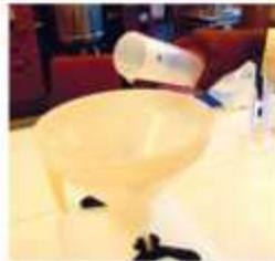
2. Ajouter le peroxyde d'hydrogène (H<sub>2</sub>O<sub>2</sub>) en utilisant un cylindre gradué.
