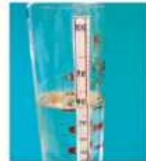
2. Les contrôles des produits finis sont obligatoires lorsque de l'éthanol ou une solution d'isopropanol sont utilisés. Contrôler la concentration finale de la solution à l'aide d'un alcoomètre. Les limites d'acceptabilité sont égales à  $\pm 5\%$  de la concentration finale (75-85% pour l'éthanol).
