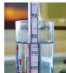
3. L'alcoomètre présenté dans ce document est utilisé pour mesurer la concentration en éthanol. S'il devait être utilisé pour mesurer la concentration en isopropanol, une solution à 75% indiquera 77% ( $\pm 1\%$ ) sur l'échelle, à une température de 25°C.
